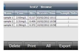
**[01]** Utilice el espacio de trabajo Quantitative para construir curvas de calibración y medir la concentración de muestras. Se pueden generar curvas de 1er – 4º orden y tanto los métodos como los datos de medida se pueden guardar en la memoria del equipo.
