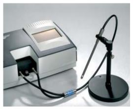
[02] Utilice la sonda de fibra submergible para determinaciones in situ.
